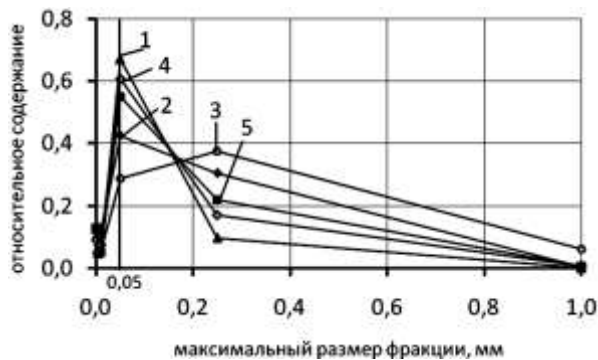
Рис. 2. Полигон частотного распределения гранулометрических элементов легкосуглинистых почв по фракциям Fig. 2. Polygon of the frequency distribution of grain-size composition soil
