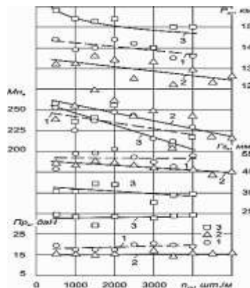
Рис. 2. Изменение прочности Pr_v , гибкости Gb_v , метрического номера Mn_v волокна и расчетной добротности пряжи P_{дп} в зависимости от плотности лент разостланной соломы n_{см} : 1–3 – годы исследований Fig. 2. The change in density Pr_v , flexibility, Gb_v , metric count Mn_v of fiber and estimated soundness of yarn P_{дп} depending on the density of spread straw strips n_{см} : 1–3 – the years of investigations
