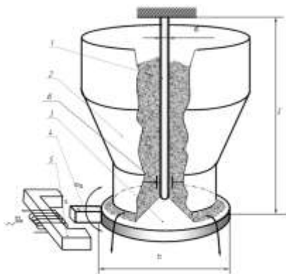
Рис. 1. Схема вибрационного дозатора сыпучих кормов: 1 – упругий элемент; 2 – бункер; 3 – рабочий орган; 4 – постоянный магнит; 5 – электромагнитный вибратор; 6 – подшипник Fig. 1. Scheme vibrating friable forages dozer: 1 – elastic element; 2 – bunker; 3 – working body; 4 – permanent magnet; 5 – electromagnetic vibrator; 6 – bearing
