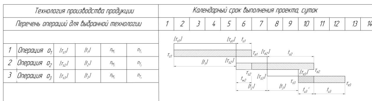
- Своевременное выполнение операции; - Выполнение операции с потерями; - Ожидание выполнения операции без потерь; - Директивный срок выполнения операции; - Ожидание выполнения операции с потерями;
