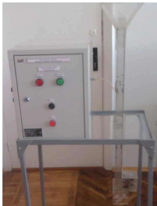
Рис. 1. Внешний вид лабораторной опытной установки для уничтожения насекомых-вредителей в сильном электрическом поле
