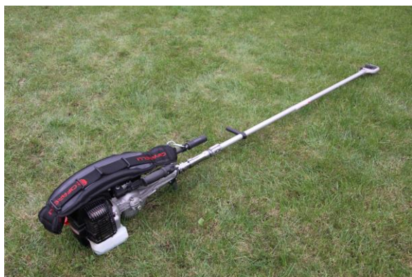
Рис. 1. Ручной виброударный стряхиватель плодов: а – схема; б – общий вид стряхивателя; в – общий вид ударного механизма
