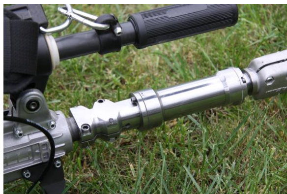
Рис. 1. Ручной виброударный стряхиватель плодов: а – схема; б – общий вид стряхивателя; в – общий вид ударного механизма
