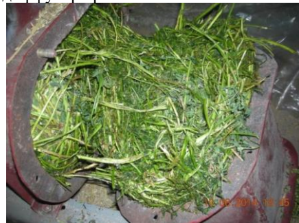
Рис. 1. Уплотнение растительного сырья в двухшнековом уплотнителе
