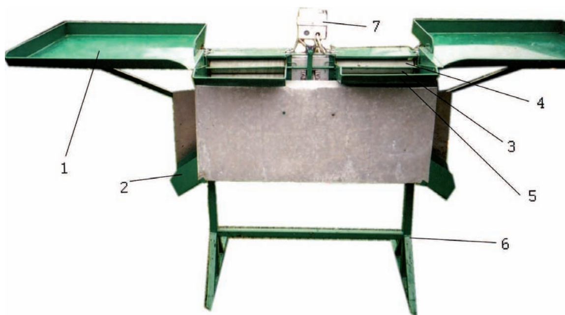
Fot. 1. Łuszcarka do bobu ŁB-2 (widok z przodu): 1–stoły podawcze, 2–zsypy na wyłuszczoney bób, 3–stoły robocze, 4–wałki łuszczące, 5–kratki zabezpieczające, 6–rama
