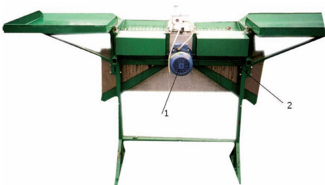
Fot. 2. Łuszcarka do bobu ŁB-2 (widok z tyłu): 1–silnik elektryczny, 2–zsypy na wyłuszczone strąki Fot. 2. The sheller of vicia faba ŁB-2 (rear view): 1 – electric motor, 2 – pods chute
