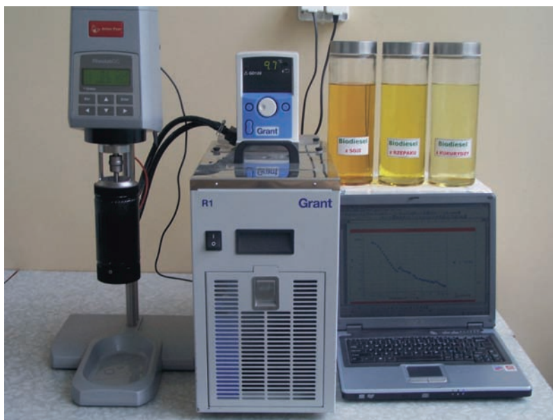
Rys. 1. Stanowisko badawcze wyposażone w reometr oraz wannę termostatyczną Fig. 1. The researchers post was furnished with a reometer and tub thermostats
