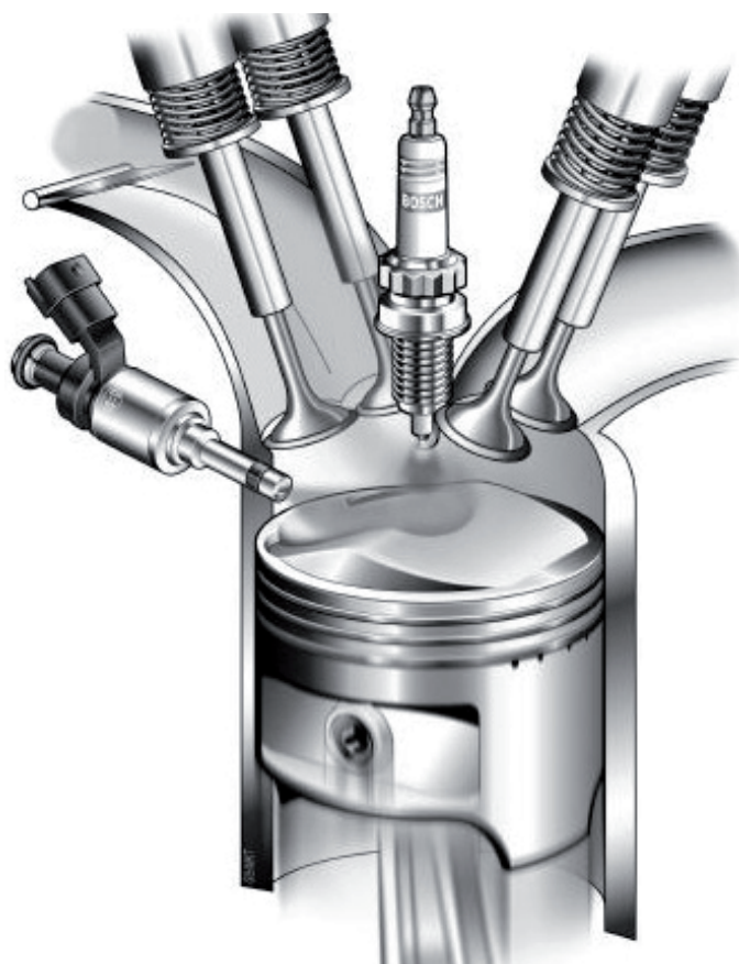
Rys. 6. Przykład rozwiązania typu DGI. Wtryskiwacz umieszczony z boku cylindra [Dyszy 2008]
