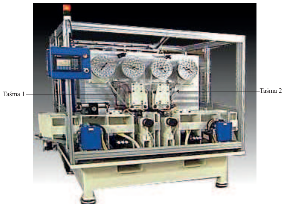
Rys. 10. Fotografia obrabiarki do mikrowyglądania powierzchni walcowych FTS [11] Fig. 10. The photograph of machine tool to micro-smoothing with FTS of cylindrical surfaces [11]
