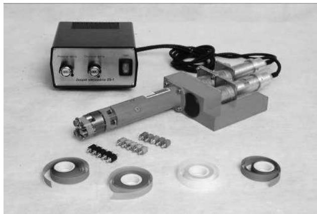
Rys. 13. Głowica do oscylacyjnego mikrowygładzania otworów foliowymi taśmami ściernymi z zespołem sterowania ZS-1, typu GO-2 [2, 3]
