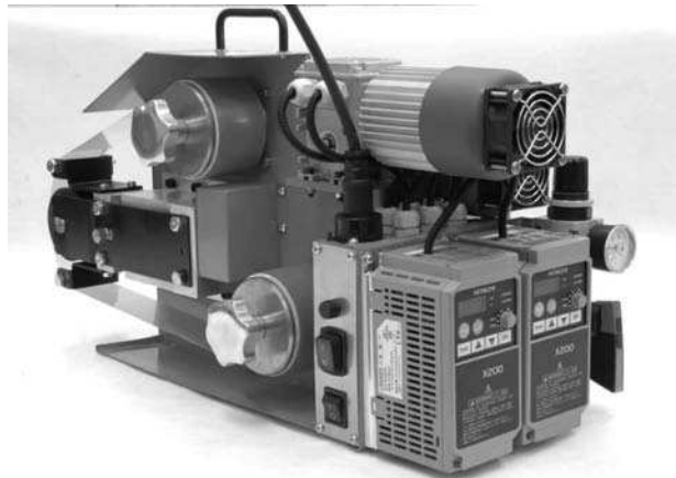
Rys. 12. Głowica typu GW-1 do mikrowygładzania zewnętrznych powierzchni walcowych foliowymi taśmami ściernymi [1, 3]
