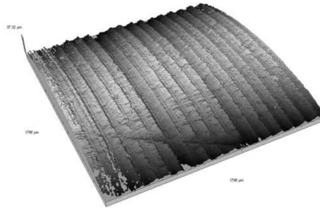
Rys. 23. Profilogram powierzchni toczonej narzędziami diamentowymi wałka ceramicznego W7 o R_{ao}=1,637 \mu\text{m} [6] Fig. 23. Profilogram of the surface waged with diamond tools of ceramic shaft surface W7 when R_{ao} = 1.637 \mu\text{m} [6]
