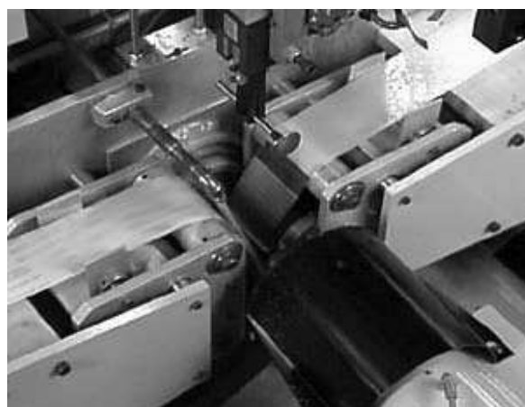
Rys. 11. Fotografia strefy obróbki podczas bezkłowego mikrowyglądania powierzchni trzonek zaworów silników spalinowych FTS [11] Fig. 11. The photograph of processing area of centerless micro-smoothing with FTS of combustion engine valve stem surface [11]
