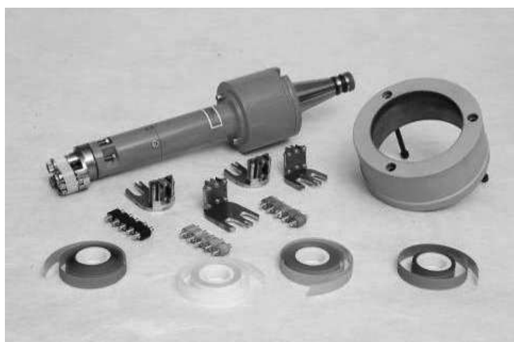
Rys. 15. Głowica do oscylacyjnego mikrowyglądania nieobrotowych cylindrów foliowymi taśmami ściernymi, typu GO-4 [2, 3]
