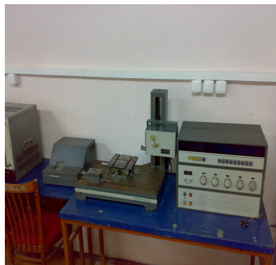
Рис. 4. Общий вид профилографа-профилометра М – 252 Fig. 4. A general view profilografa-profilometra М – 252
