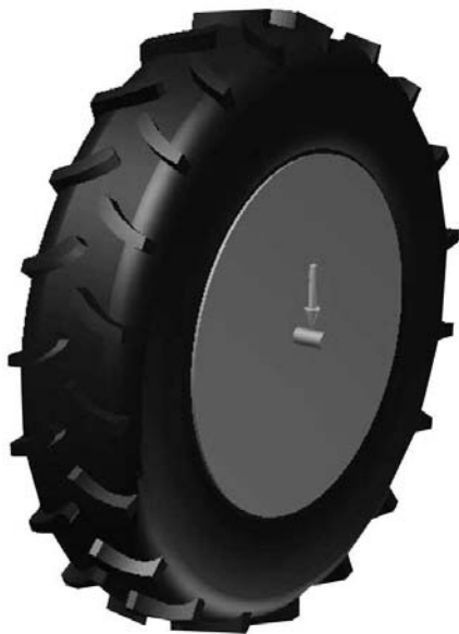
Rys. 1. Cyfrowy model bryłowy koła napędowego z oponą 14.9R28/8PR
