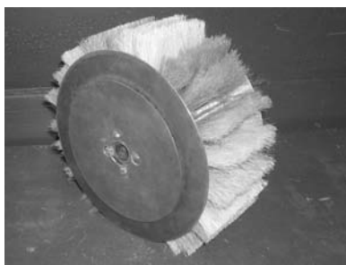
Рис. 4. Общий вид лопастного ротора Fig. 4. A general view of the rotor blade
