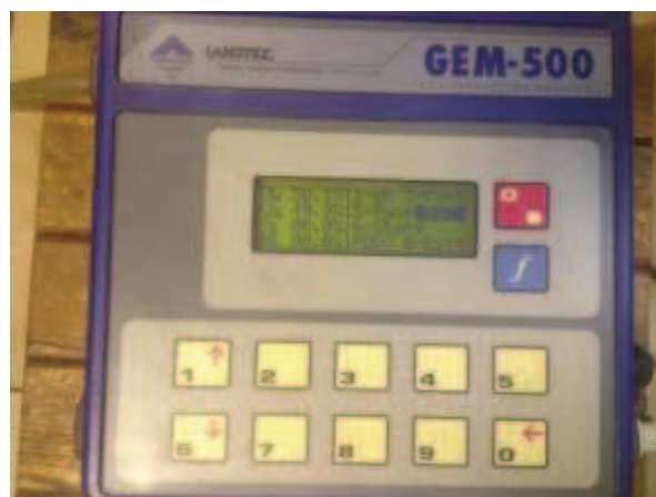
Рис. 9. Измерение элементного состава биогаза газоанализатором GEM-500
