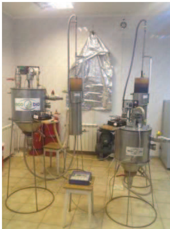
Рис. 2. Экспериментальные биогазовые установки во время определения элементного состава биогаза
