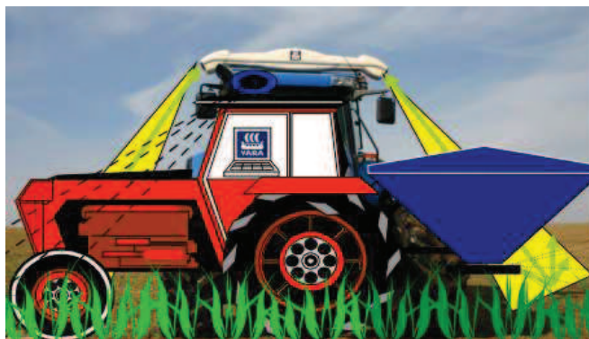
Рис. 4. Принципиальная схема реализации мониторинга, ближнего, с помощью системы технического зрения размещенной на транспортном средстве
