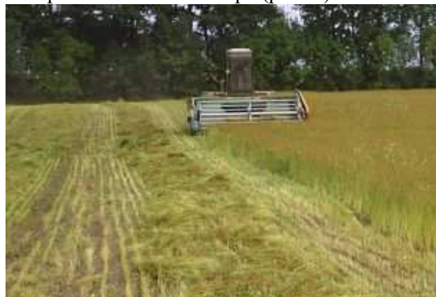
Рис. 2. Жатка ЖНР-4 на скашивании льна-долгунца
