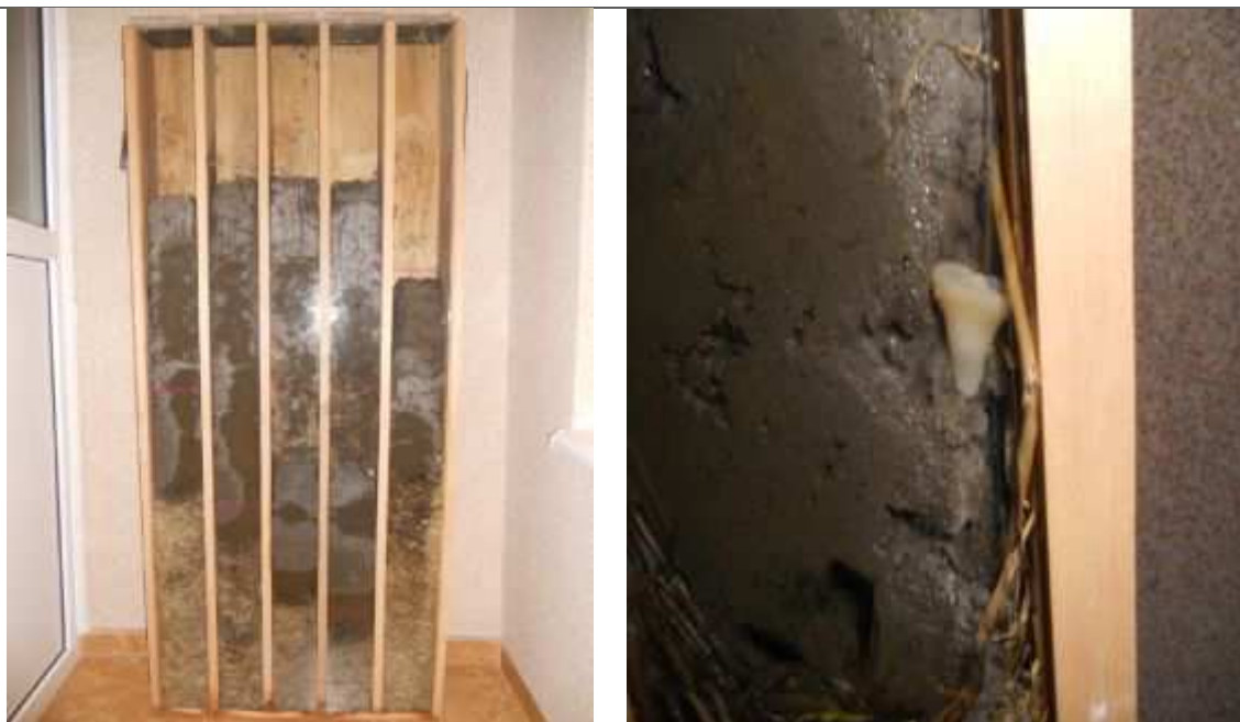
Рис. 3. Изменение состояния заложенных материалов после 50 дней (а) и появление грибов (б) на стыке измельчённой соломы и сапропеля
