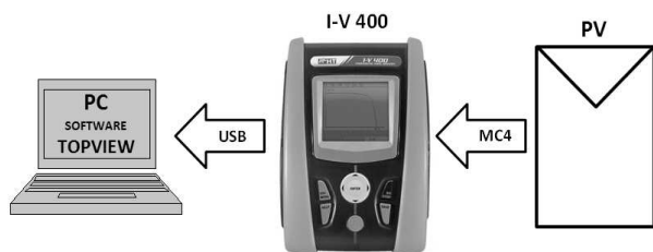
Rys. 2. Schemat połączeń podczas pomiarów charakterystyk I-V Fig. 2. Wiring diagram for the measurement of I-V characteristics
