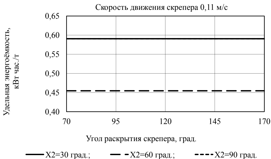
Рис. 1. Зависимость удельной энергоёмкости усовершенствованной скреперной установки от угла раскрытия скрепера
