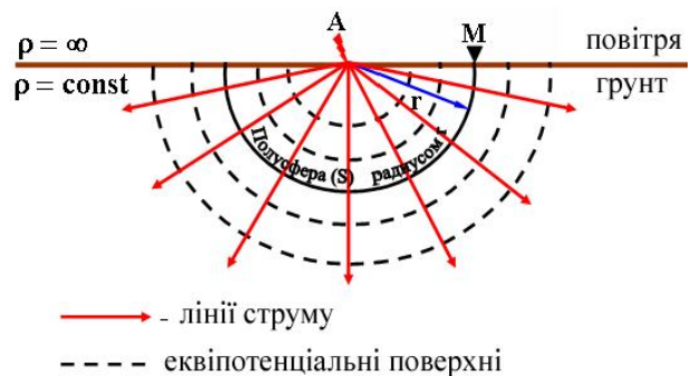
Рис. 4. Поле точечного источника постоянного тока, над однородным разрезом Fig. 4. Field of point source of direct current, above a homogeneous cut
