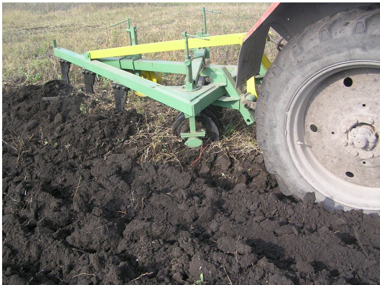
Рис. 1. Плуг с дисковым измельчителем в работе Fig. 1. Plough rotary chopper in the work
