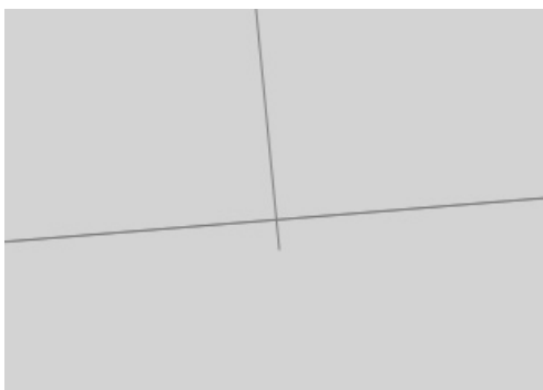
Rys. 8. Błąd przeciągnięcia Źródło: Tempiński B., 2015
