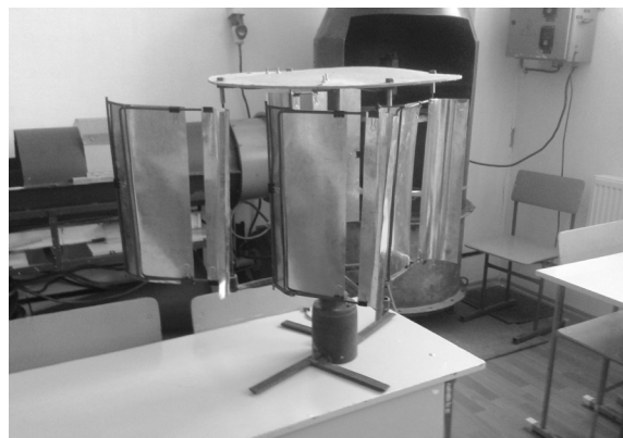
Рис. 7. Лабораторная модель ветродвигателя (вариант лопастей с окнами)
